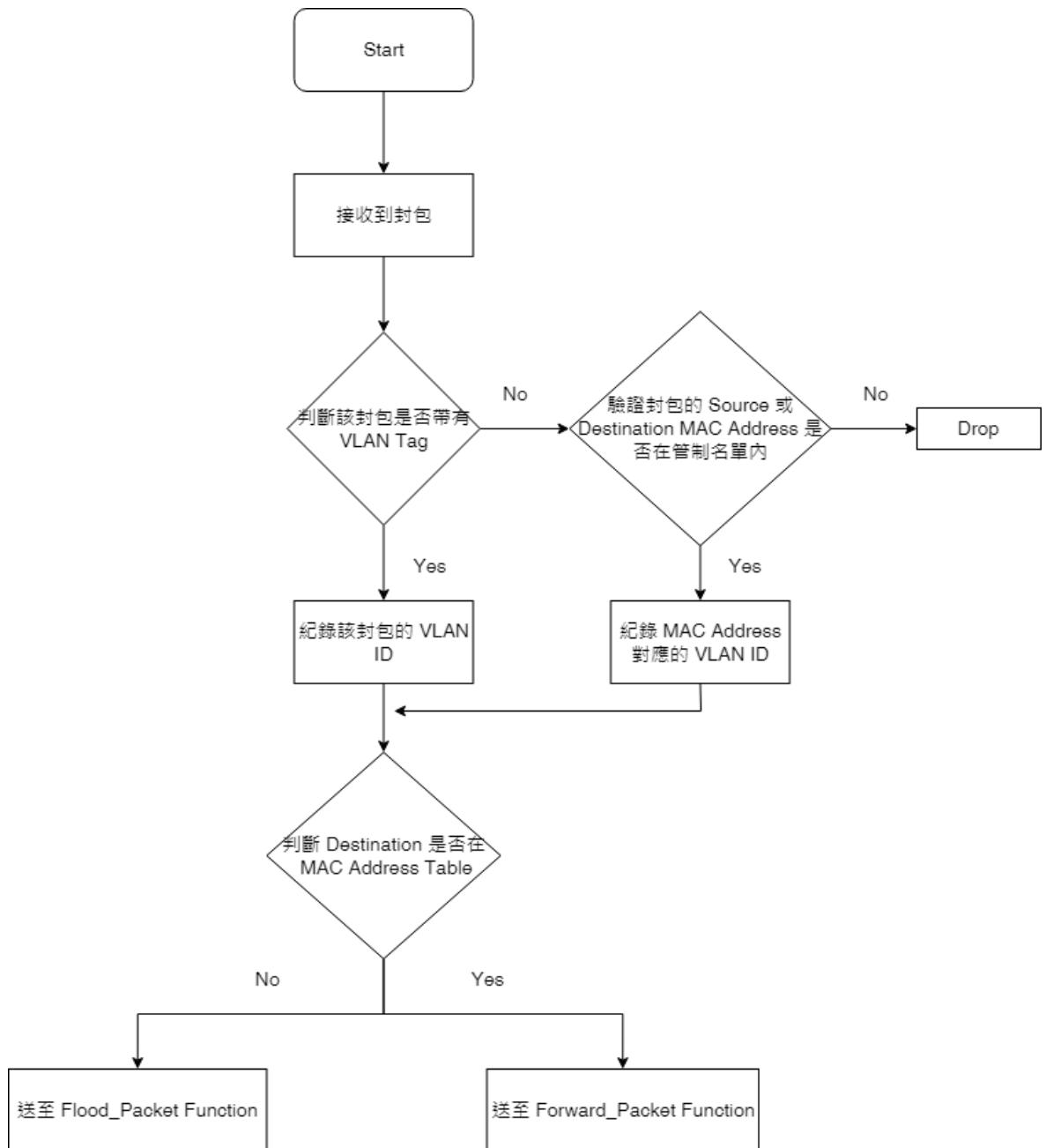
圖十五 Packet-In Function Flowchart
