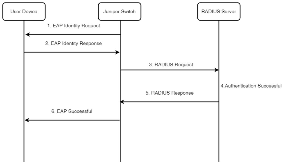
圖十 RADIUS EAP 流程
