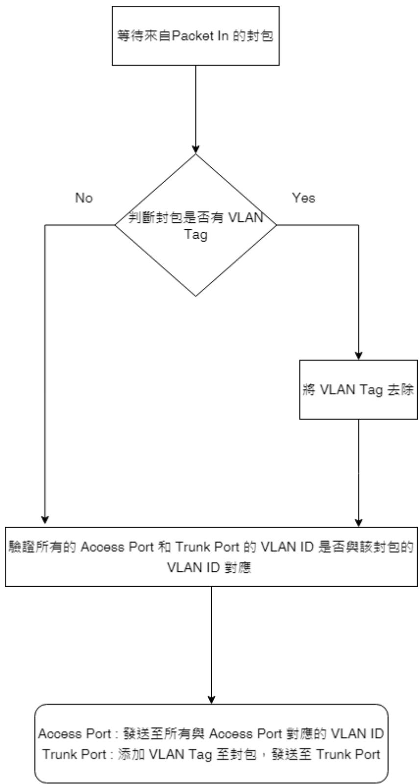
圖十六 Flood\_Packet Function Flowchart
