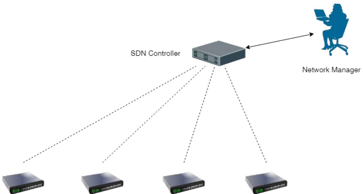
圖六 網路管理者使用 SDN Controller 控制網路設備示意圖
