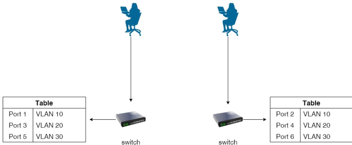
圖一 傳統網路交換機查詢/設定 VLAN 方式
